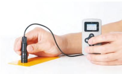
NFe基探头检测喷涂在非磁性金属基底(比如铝、铜、黄铜、不锈钢等)上所有绝缘涂层厚度,例如油漆层、喷粉层、涂瓷层等。
